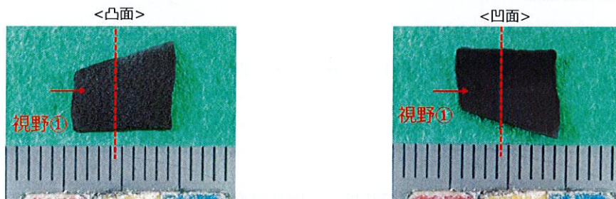
C－S G 第三管支持板上面（低温側）から回収したスケール
