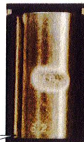
図 2 ウォータージェットテスト後の外観 (700分間水噴流後の状況)
