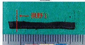
A－S G 第一管支持板上面（高温側）から回収した長尺型スケール <凸面> <凹面>
