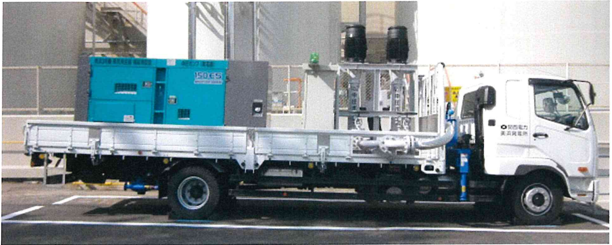
【図表 4 6 蒸気発生器補給用仮設中圧ポンプ】
