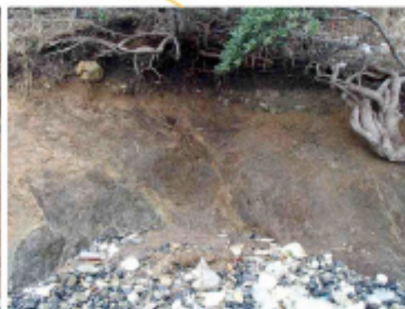
写真③: 関西電力が従来F-6としていた角礫状破砕帯
